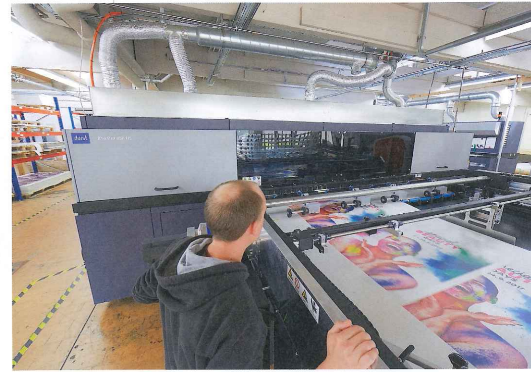
Der Rho P10 250 HS der Firma Durst ist eine Produktionsmaschine, die im 24/7-Betrieb weitgehend autonom arbeitet.
