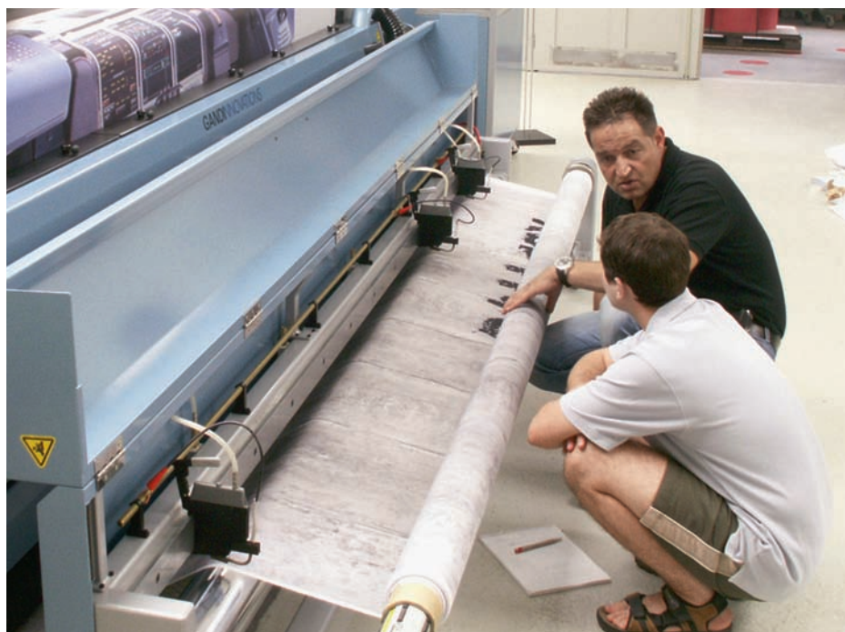
Europas erster Direct-to-Fabric-Printer Jeti 3324 Aquajet des kanadischen Herstellers Gandinnovations produziert bei der PlotFactory.
